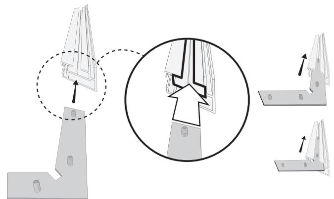
2/ Insérer équerres + contre équerres à chaque extrémité d'un profilé. Jusqu'en butée (ne pas serrer).
