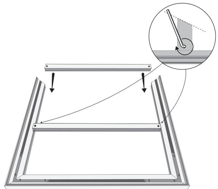
4/ Variante stabilisateurs, glisser le ou les stabilisateurs jusqu'au milieu et serrer. Rééditer l'opération n° 3 pour fermer votre cadre et passer au montage de la toile.
