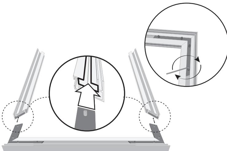
3/ Former un «U» avec deux autres profilés, ajuster les angles et serrer avec la clé n° 2,5.
