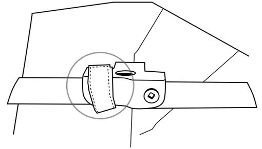
Fixer les scratches à l'armature au niveau des connexions seulement une fois la tente ouverte à 100%
