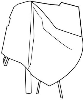
Positionner correctement chaque angle du toit aux angles de la structure
