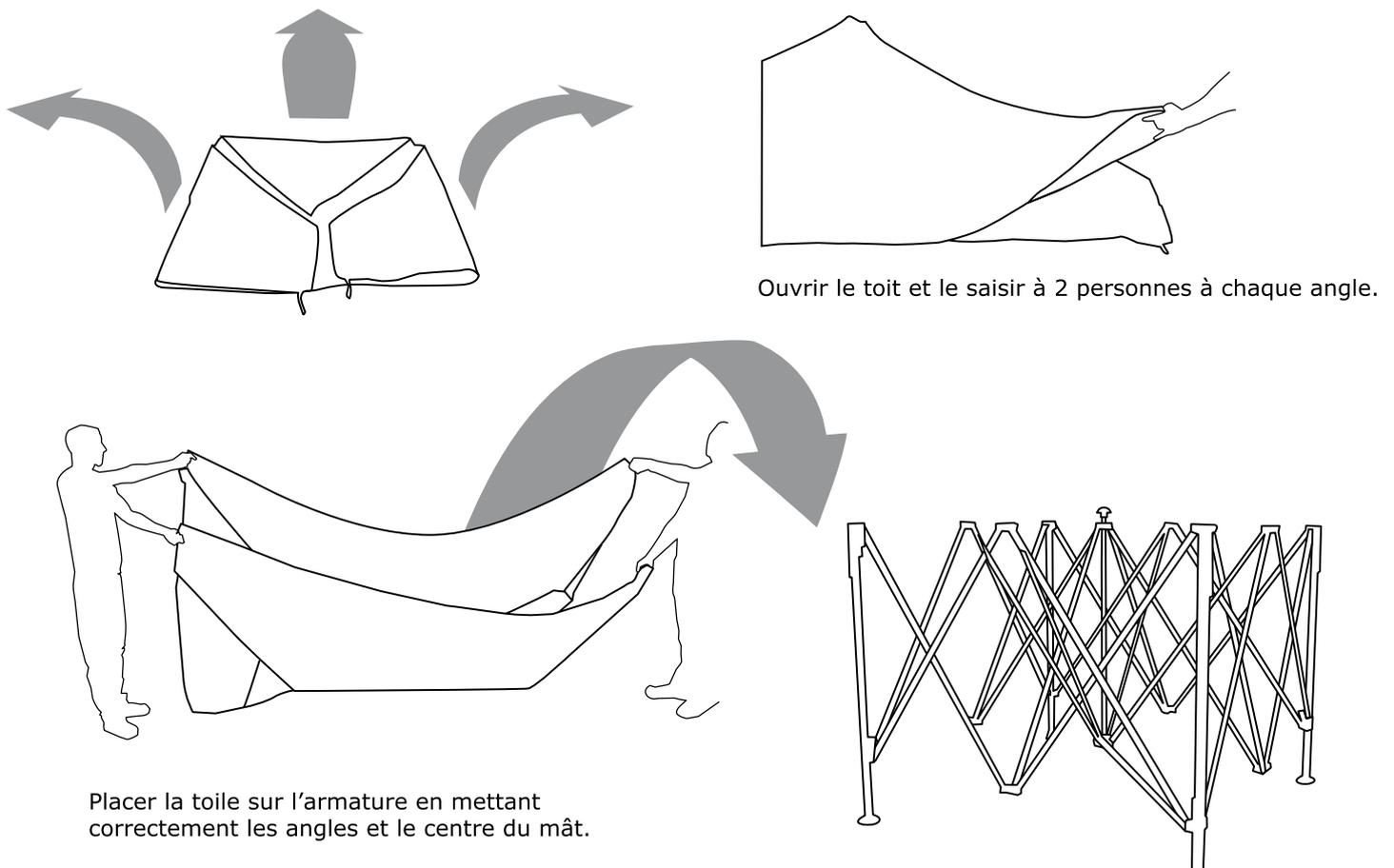
Placer la toile sur l'armature en mettant correctement les angles et le centre du mât.
