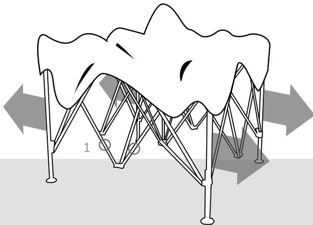
Se positionner à 2 face à face. Pour ouvrir la structure saisissez les ciseaux (1) et tirer vers vous tout en reculant. le mât de la tente va monter, l'armature va se déployer. Il vous reste à la verouiller en clipsant les poignées à chaque coin. Le verouillage se fait automatiquement.
