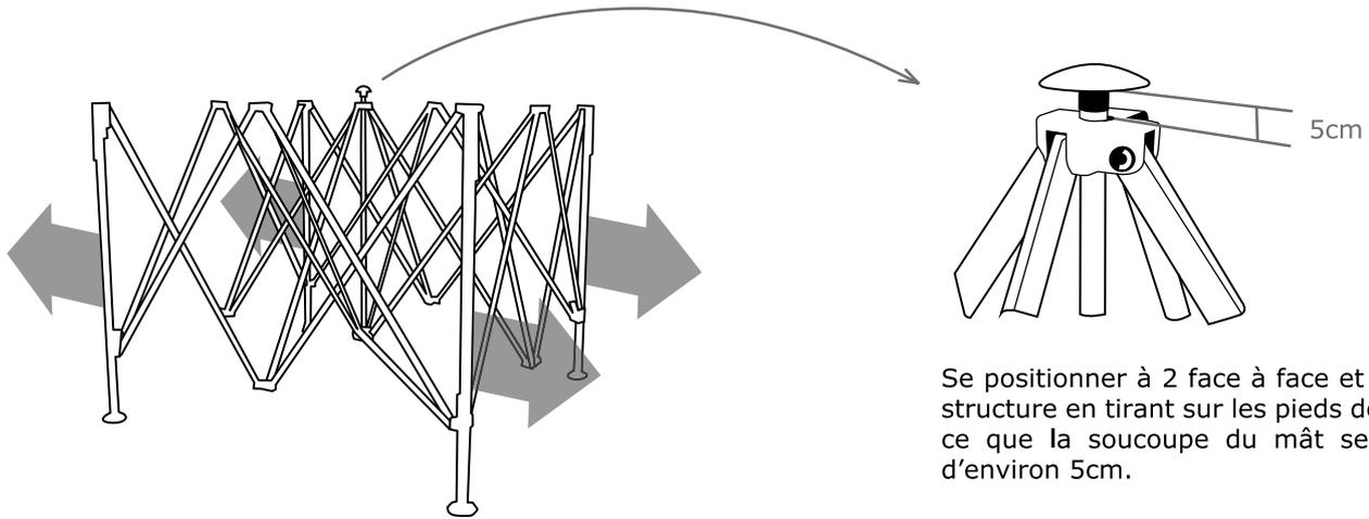
Se positionner à 2 face à face et ouvrir la structure en tirant sur les pieds de façon à ce que la soucoupe du mât se soulève d'environ 5cm.
