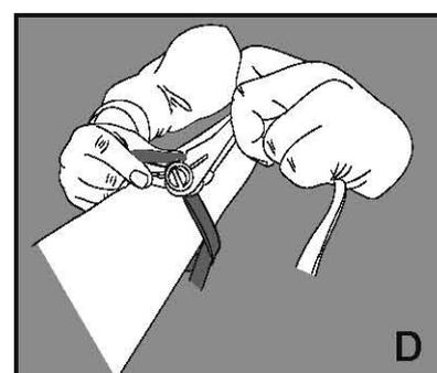
► Tendre la 2ème sangle à cliquets. Ajuster la position de la potence et bloquer les 2 sangles. Bien serrer.
