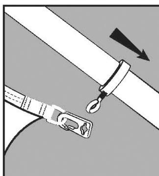
▶ Passer ensuite le mousqueton sur l'anneau « D » du pavillon, l'attacher sur la bague.
