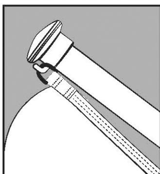
▶ Ajuster la hauteur selon le pavillon et serrer la bague avec la vis prévue à cet effet.
