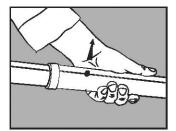
► Emboîter les éléments jusqu'à ce que le cliquet apparaisse et bloque le mât pour assurer la rigidité de l'ensemble (voir ci-contre).
