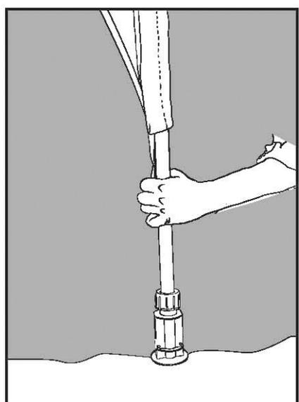
► Mettre le mât dans le tire-bouchon et serrer l'écrou
