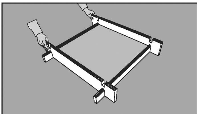
► Emboîter l'ensemble avec la plaque de fond dans les 2 lames de départ **3**. La rainure (coté femelle) se présente toujours vers le bas. Utiliser un maillet pour encaster solidement les lames.
