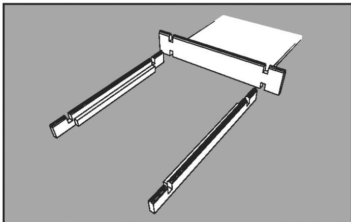
► Emboîter la plaque de fond **1** dans les 2 lames de départ **4** (des encoches sont prévues à cet effet).
