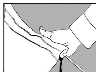
► Enfiler la voile sur le jonc **E** jusqu'au tube **A**
