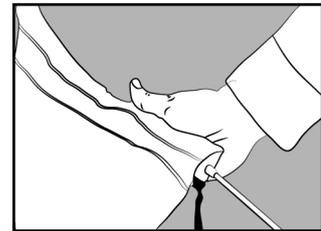
► Enfiler la voile sur le jonc **(D)** jusqu'au tube **(A)**
