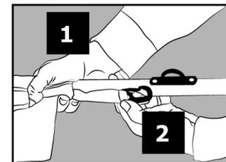
► Fixer le mousqueton de la voile sur le pontet existant du tube **(A)**
