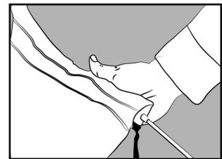
► Enfiler la voile sur le jonc **C** jusqu'au tube **A**
