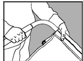
► **Fixer le mousqueton** de la voile sur le pontet existant du tube, **A** et ajuster si nécessaire\*
