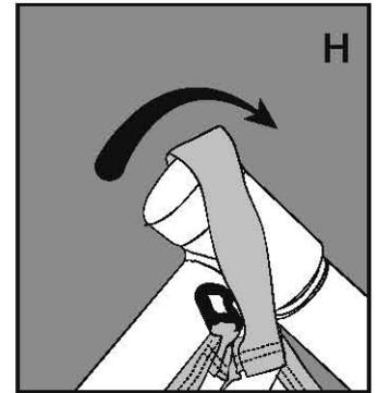
► Accrocher le mousqueton en plastique sur l'œillet de la potence prévu à cet effet. (image I). Bien pousser le mousqueton pour que celui-ci ne bouge plus.
