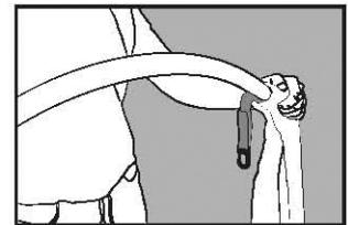
► **Fixer le mousqueton** de la voile sur le pontet existant du tube, **A** et ajuster si nécessaire\*
